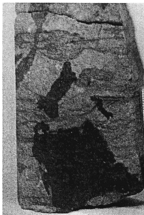
Abb. 87: Überzüge von Uranschwärze (= schwarze Flecken) auf einer Kultfläche im „Wurmsandstein“. Bohrung 1916, Teufe 197,3 m
