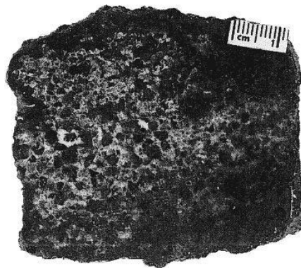
Abb. 74: Quarzsandstein, grobkörnig, grau, Uranschwärze in dunklen verwaschenen Flecken (z. B. oben rechts), Zentralzone, 3. Erzhorizont, ctr 2 , Zuflusssenkung „Schacht 387-Forsthausweg“, Steigort 1, Probe 1883
