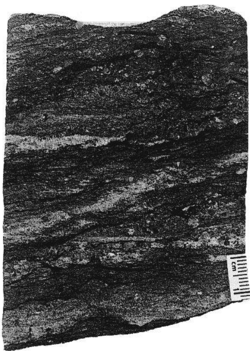
Abb. 60: (links Gesteinsaufnahme, rechts Radiographie): Sandstein, feinkörnig, mit kohlig-tonigen Schlieren und örtlich koncretionärem Pyrit. Erzfeld Pirna, 3. Erzhorizont. Terrestrisches Cenoman, Flußauenschichten (ctr 2 ), Bahra-Kirchberger Zuflußsenke, Bohrung 2722, Teufe 240 m, Probe 1441/78
