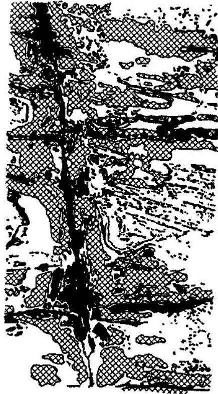
b) Pechblende und Eisenoxidhydrate in fein- bis grobkörnigem Sandstein, Darstellung eines Grubenaufschlusses etwa 1 : 1
