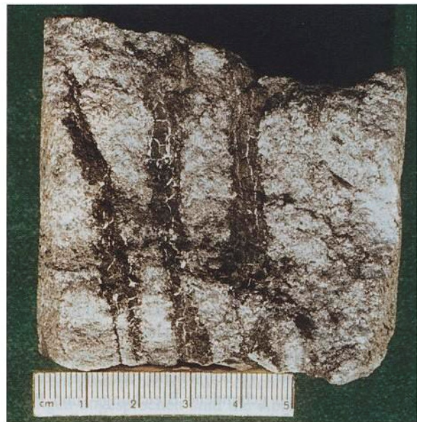
Abb. 14 (links): Sandstein, stark tonig, mit Linsen eines hellgrauen feinkörnigen Sandsteins. Die das Gestein durchziehenden kohligen Lagen sind reichlich pyritdurchstaubt, Flußauenschichten ( ctr_2 ); Bohrung 1273, Teufe 224 m. Foto: D. KÖRNER.
