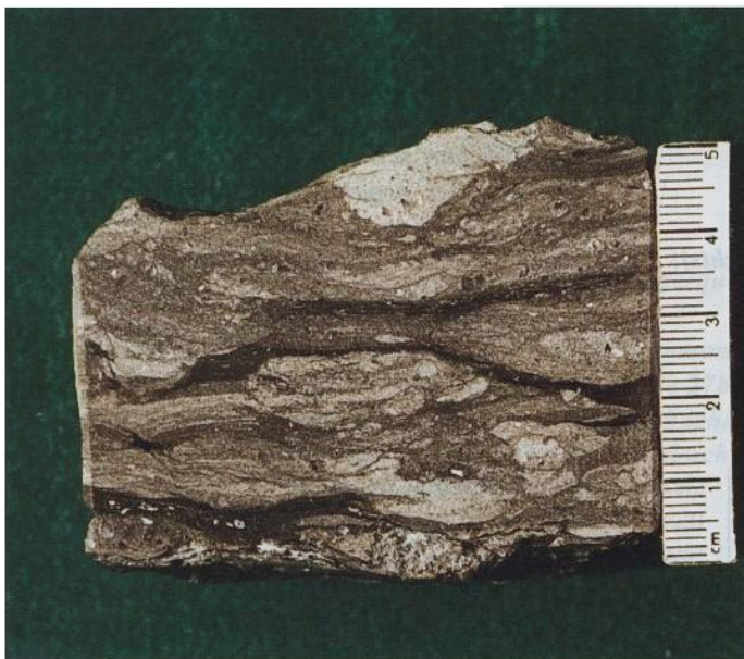
Abb. 14 (links): Sandstein, stark tonig, mit Linsen eines hellgrauen feinkörnigen Sandsteins. Die das Gestein durchziehenden kohligen Lagen sind reichlich pyritdurchstaubt, Flußauenschichten ( ctr_2 ); Bohrung 1273, Teufe 224 m. Foto: D. KÖRNER.
